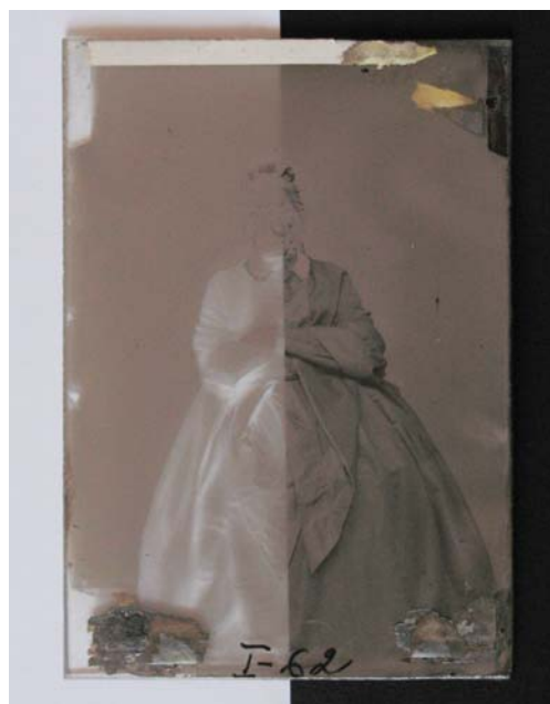
Il. 10. Negatyw ułożony na dwóch tłach: białym i jasnym. Widoczny obraz negatywowy o ciepłej barwie beżowej na białym tle i pozytywowy – na czarnym tle
