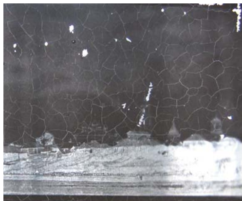
Il. 22. Spękania warstwy fotograficznej negatywu w formie puzzli i odprysków
