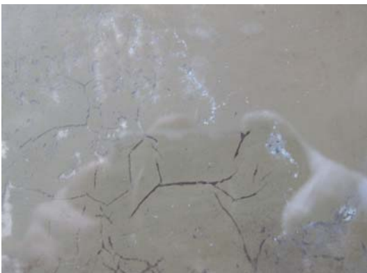
Il. 18. Efekt korozji szkła w postaci białych wysoleń wywierające destrukcyjny wpływ na warstwę fotograficzną (widok od strony szklanego podłoża negatywu)
